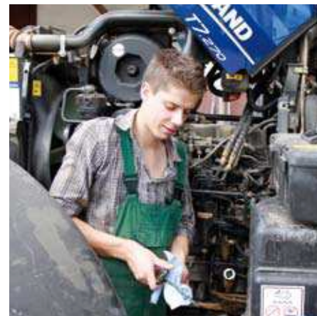
Dank einteiliger, weit öffnender Motorhaube sind alle Wartungspunkte gut zugänglich. Der Ölstand lässt sich auch geschlossen messen.
