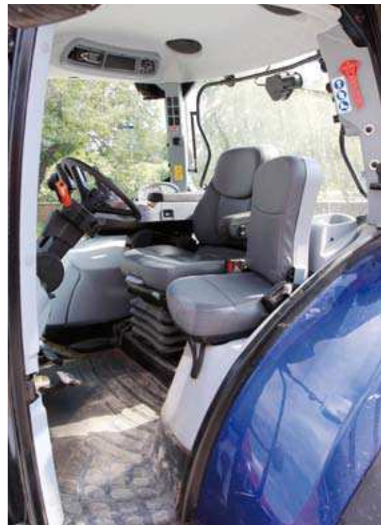
Die Kabine hat einen bequemen Aufstieg und ist mit 69 db(A) angenehm leise. Die Ledersitze sind Sonderausstattung.
