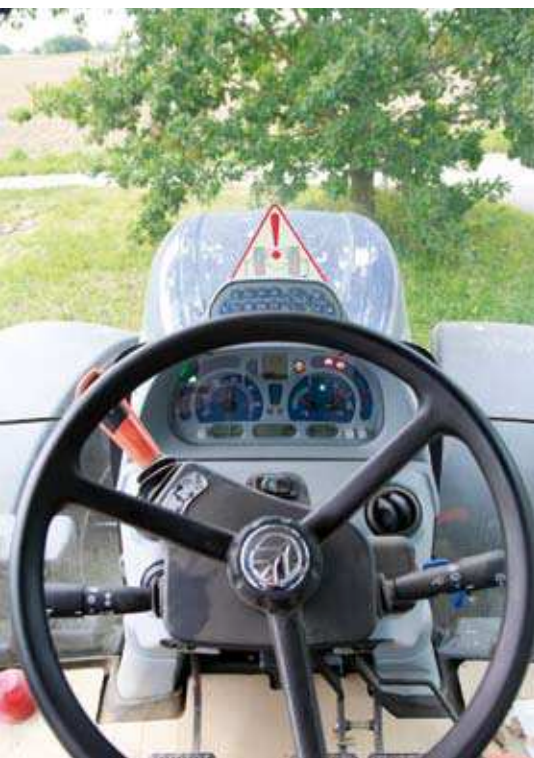
In der Wendeschaltung (oranger Hebel) ist die elektronische Parkbremse integriert, die sich automatisch bei längerem Halt aktiviert.
