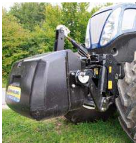
Die integrierte Fronthydraulik mit Fernbedienung hebt maximal 3.785 kg. Ein doppelwirkendes Hydraulikventil vorn ist möglich.
