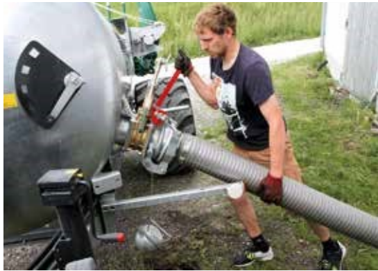
Die Andockvorrichtung für den Saugschlauch ist filigran.
