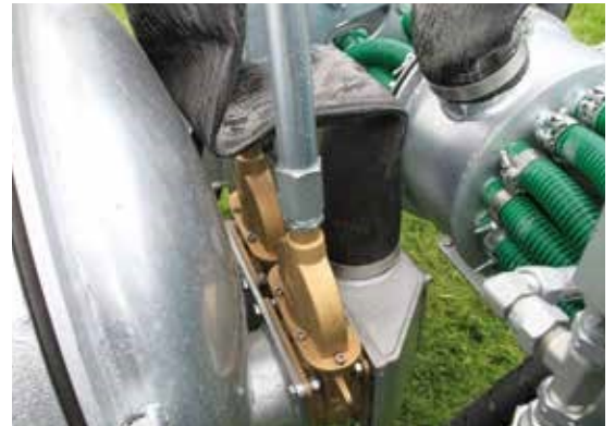
Einfaches Talfahrt-Ausbringsystem mit zwei hydraulisch betätigten Schiebern.
