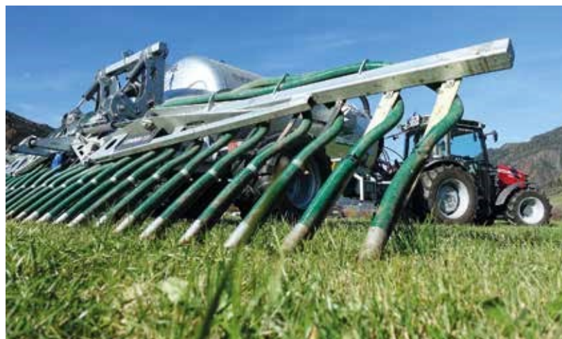
Schleppschuhverteiler Condor 7.5: wahlweise mit 30 oder 25 Abläufen (Abstand 25 cm bzw. 30 cm).
