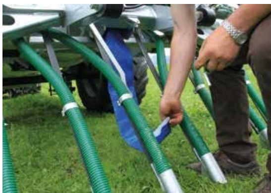
Schlauchförmiger Sack zur Fremdkörperabscheidung.
